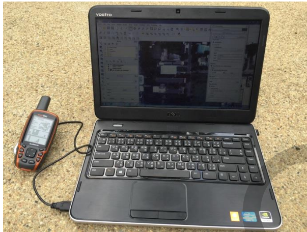
รูปที่ 21 การเชื่อมต่อสาย USB กับเครื่อง GPSMAP® 64s และโน้ตบุ๊กคอมพิวเตอร์
